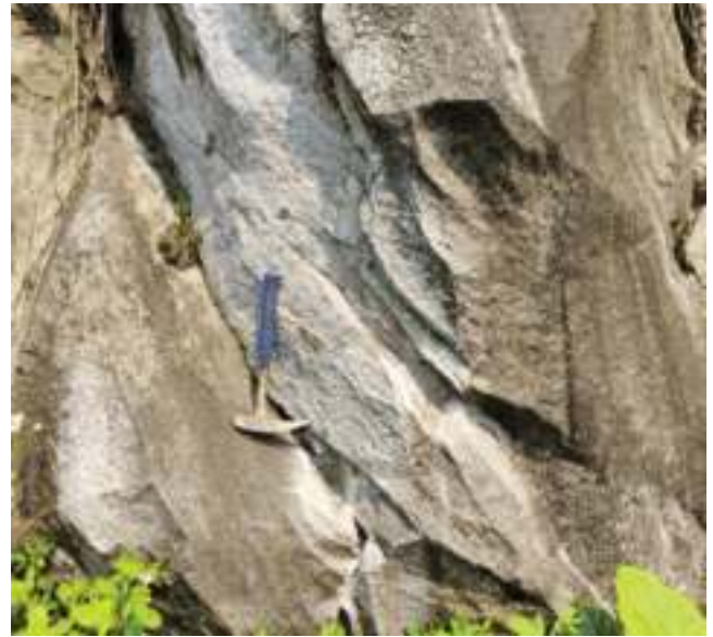
Ảnh 1. Đá granit biotit hạt vừa cấu tạo khối tại điểm khảo sát BTS2127
