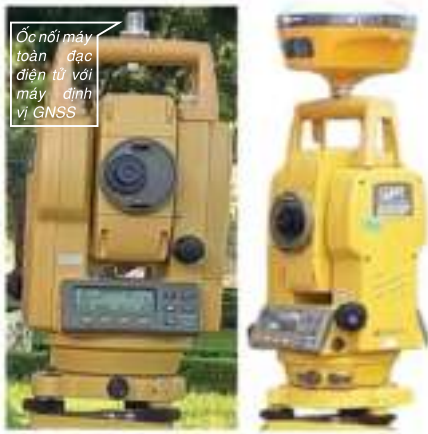
Hình 1. Máy thu GNSS được tích hợp với máy toàn đạc điện tử
